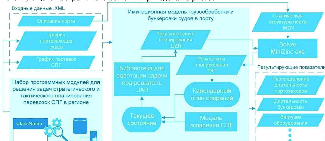
Рис. 3. Структурная схема комплексной модели портовых операций по грузообработке и бункеровке судов сжиженным природным газом
